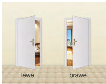
Drzwi otwierające się na zewnątrz (Z)
