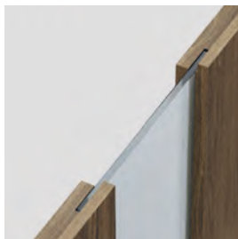
łączenie z szybą „na kant” skrzydło przylgowe
