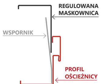
OŚCIEŻNICA REGULOWANA PU56 ZE WSPORNIKIEM
